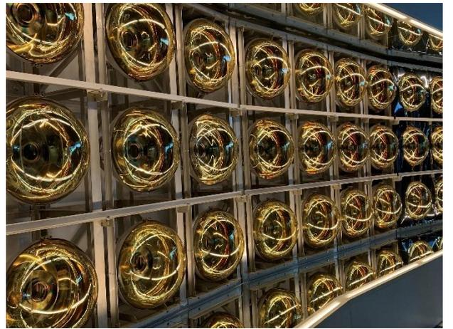
スーパーカミオカンデの内部に配置されている光電子増倍管の模型
